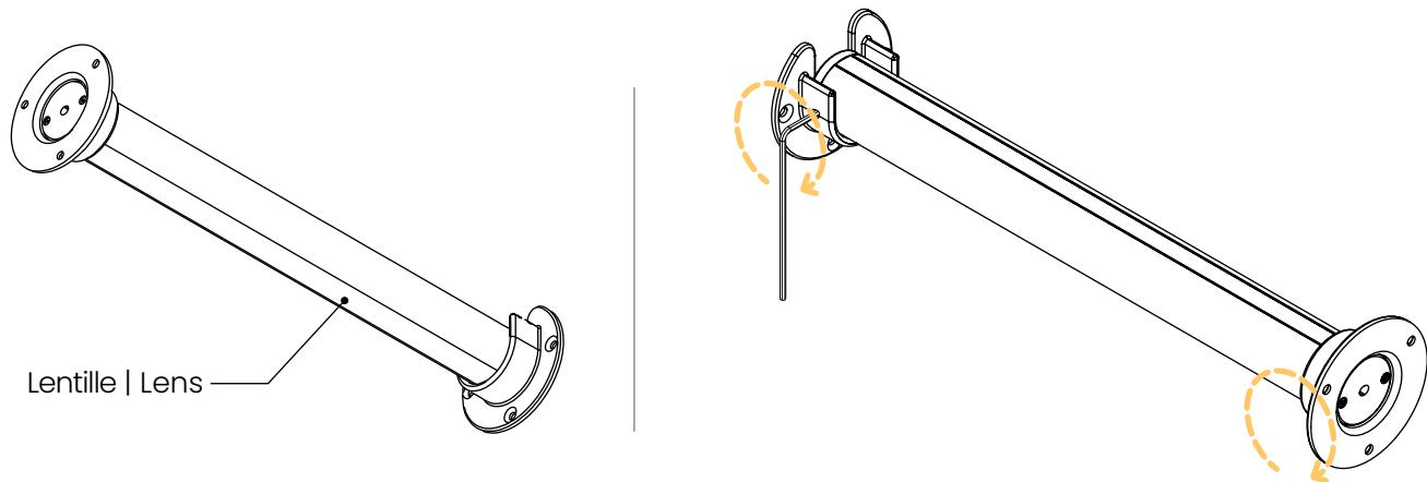
ⓘ Les *Vis Pression* ne doivent pas toucher à la *Lentille*. | The *Set Screws* must not touch the *Lens*.
