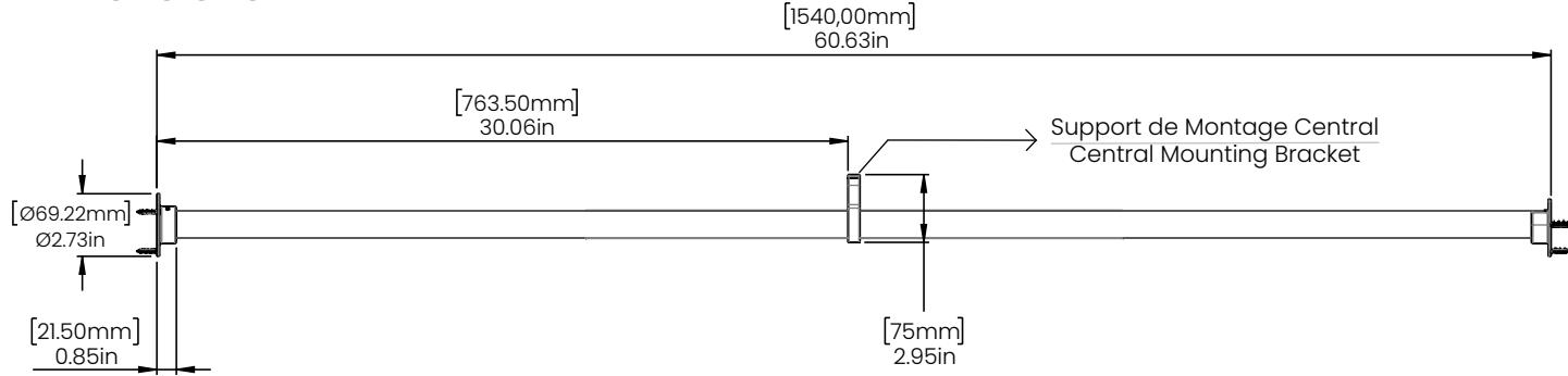
① Le *Support de Montage Central* doit toujours être réparti à une distance égale ou à un maximum de 4pi.
