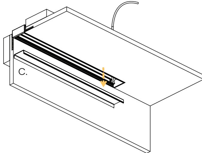
**9** Installer la *Lentille* (D) à l'intérieur de l'*Extrusion* (A).
