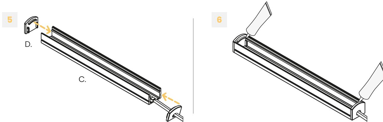
**i** Si plusieurs extrusions sont assemblées bout à bout, les embouts ne peuvent être installés qu'à chaque extrémité.
