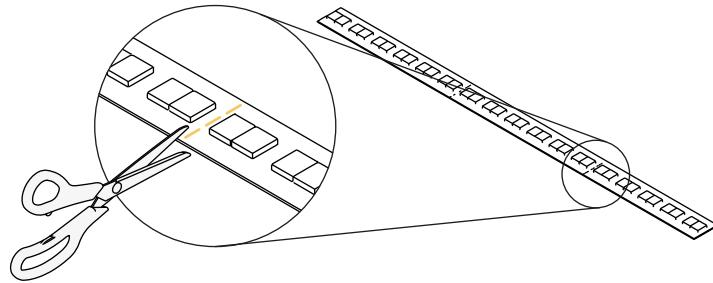
**i** Si plusieurs *Extrusions* sont installées bout à bout sans embouts entre les deux, coupez le *Ruban LED* pour couvrir la longueur **totale** de ces *Extrusions*.
