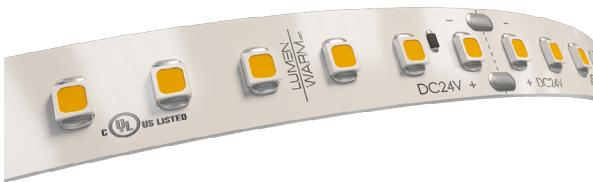
La série IC de Lumen Warm est une gamme de bandes LED de haute performance. La technologie IC intégrée garantit un flux lumineux stable tout au long de votre parcours en gérant la tension le long de la bande. Cette série offre un IRC de 95+ et un R9, une cohérence des couleurs en deux étapes et une gamme de 120 à 700 lumens par pied, avec un maximum de 120 lumens par watt.
